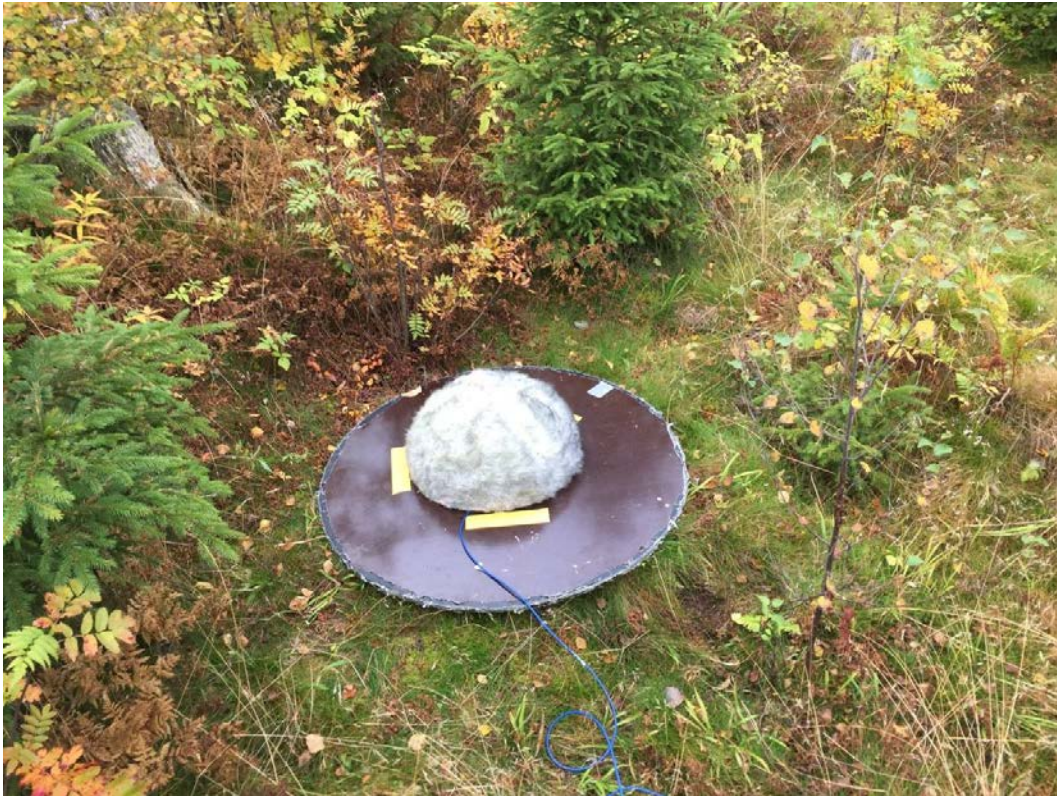
Bild 2. Mikrofon på mätplatta med vindskydd över.
