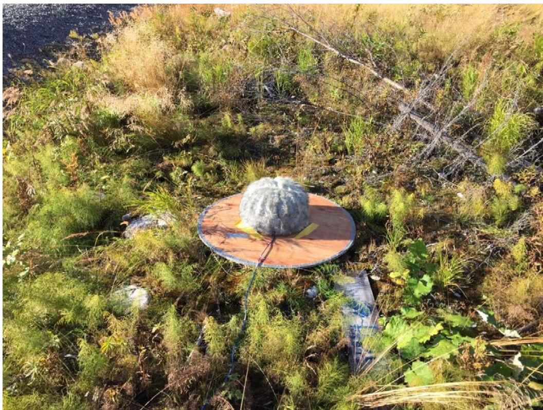
Bild 2. Mikrofon på mätplatta med vindskydd över.
